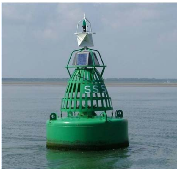
Figure 8 Bouée latérale en construction charpentée
