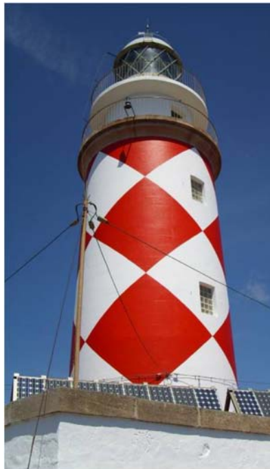
Figure 33 Utilisation de motif en losange pour une conception de marque de jour sur un phare
