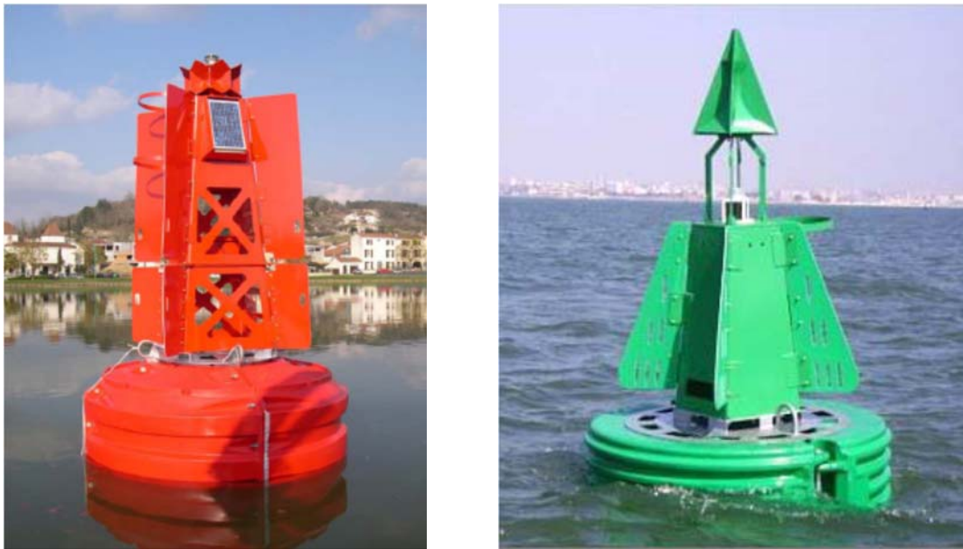
Figure 19 Bouées avec ailes dessinant la silhouette en rapport avec le type de marque
