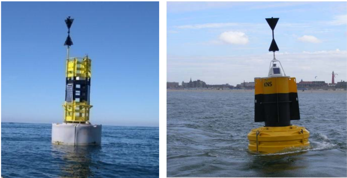
Figure 28 Exemple de bouée cardinale optimisée
