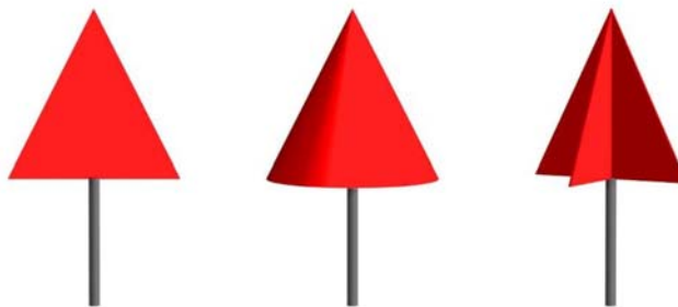
Figure 17 Marque de jour directement éclairée (panneau, cône, panneaux croisés)
